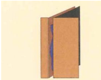
Figur 13 Spaltkorrosion (Bild hämtad från [7])
