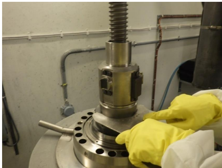
Figur 55 - Drivmutterglappsmätning i drivdonsverkstaden på Forsmark 1.
