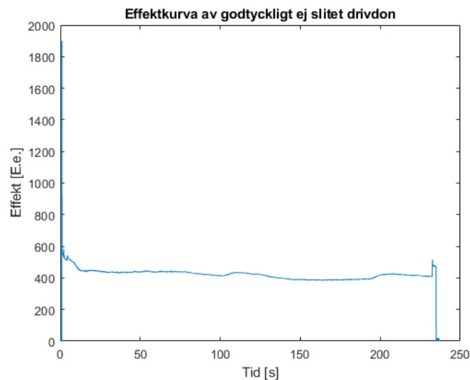
Figur 10 - Effektkurva från SODEM-datorn av ett godtyckligt drivdon nr 3, ej slitet.
